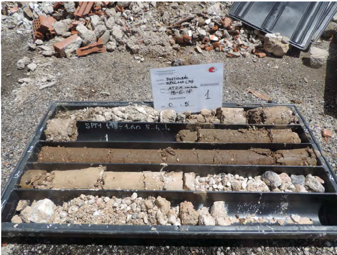
Foto 2: la cassetta con i primi cinque metri; si nota la zona in cui è stata effettuata la SPT1
