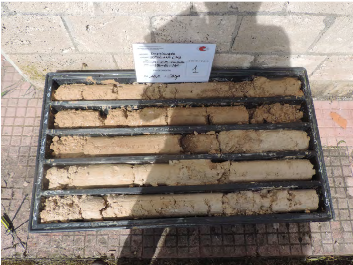
Foto 4: la cassetta con le carote comprese tra 10 e 15 metri
