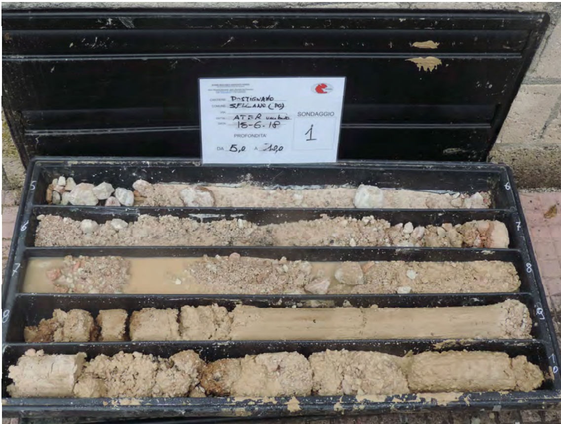
Foto 3: la cassetta con le carote comprese tra 5 e 10 metri
